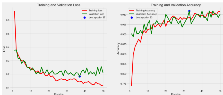
Gambar 5. Grafik Accuracy dan Loss pada VGG16 menggunakan augmentasi data
